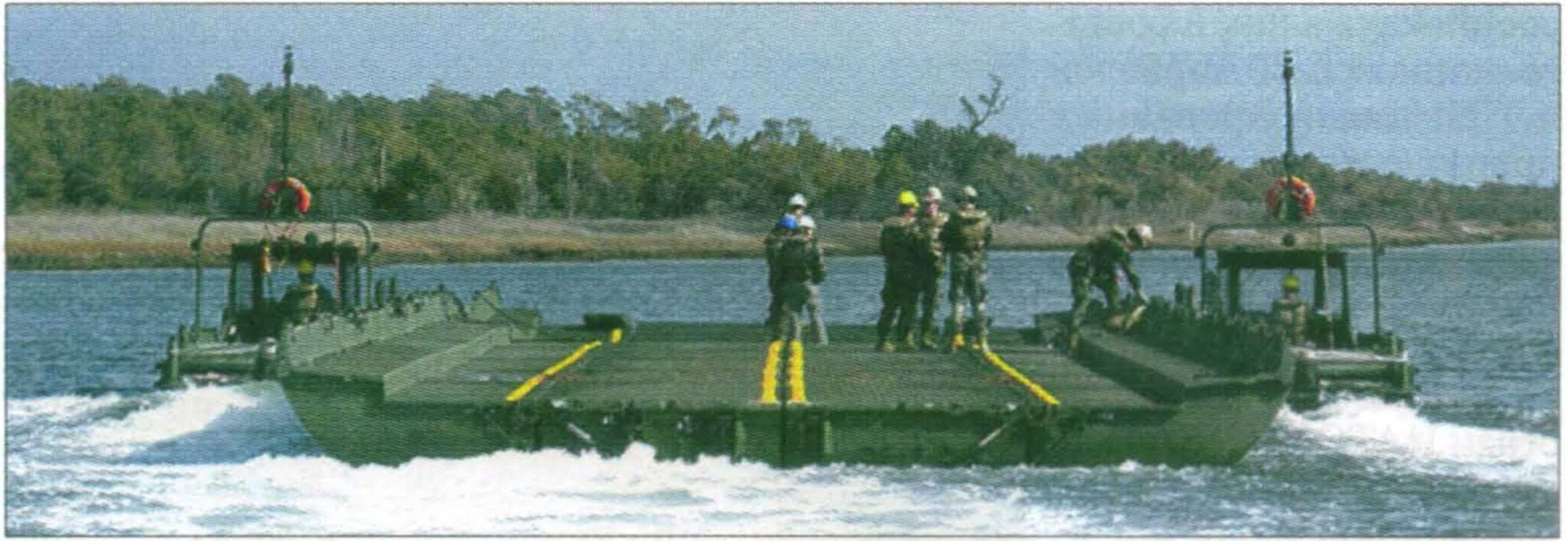
Наведение понтонного моста через водную преграду
