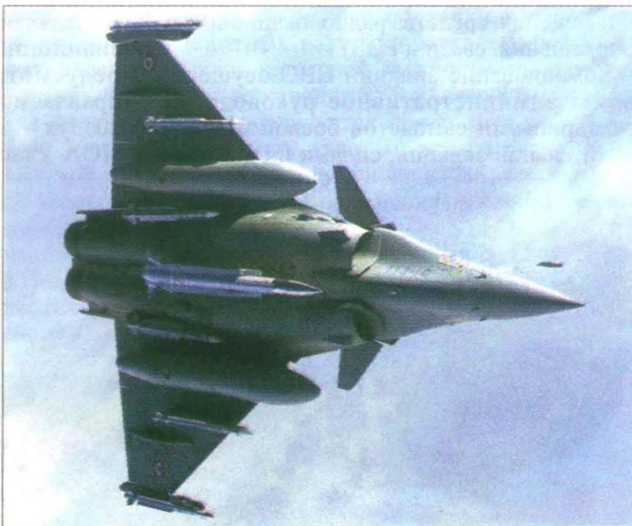
Многоцелевой истребитель «Рафаль» F.3 (на центральной подфюзеляжной точке подвески – УР ASMP-A)
