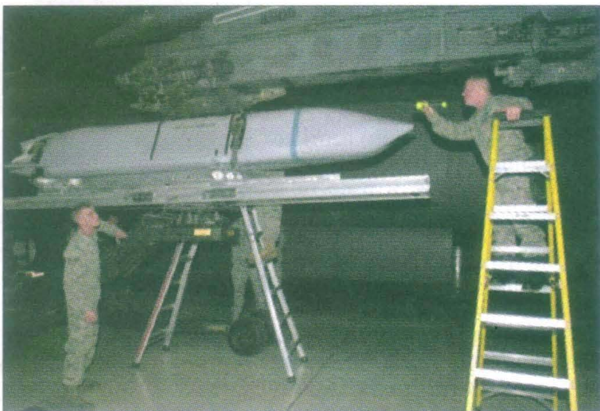
Специалисты группы авиационных средств поражения снаряжают стратегический бомбардировщик B-1B «Лансер» КРВБ AGM-158 JASSM
