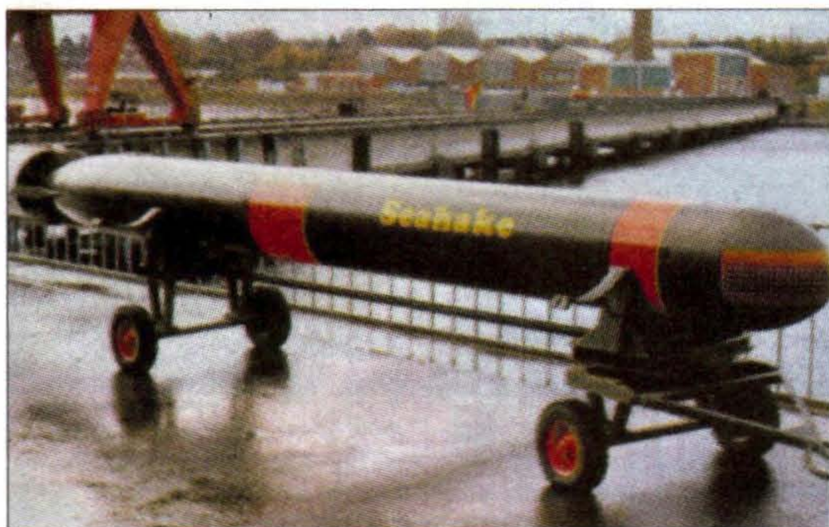
Универсальная телеуправляемая электрическая торпеда DM2A4 «Сихейк»
