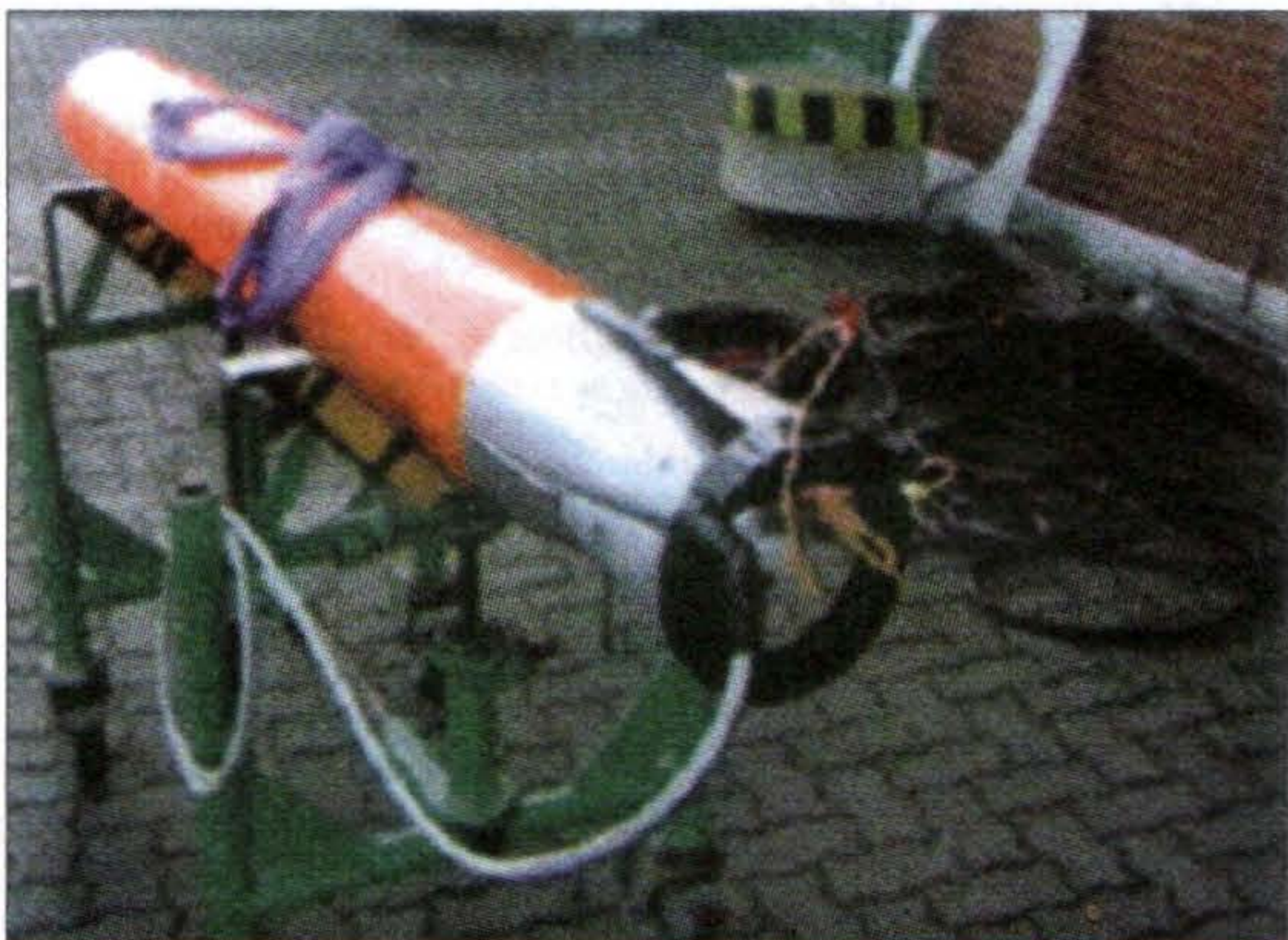
Малогабаритная 210-мм противоторпеда системы «Си Спайдер»
