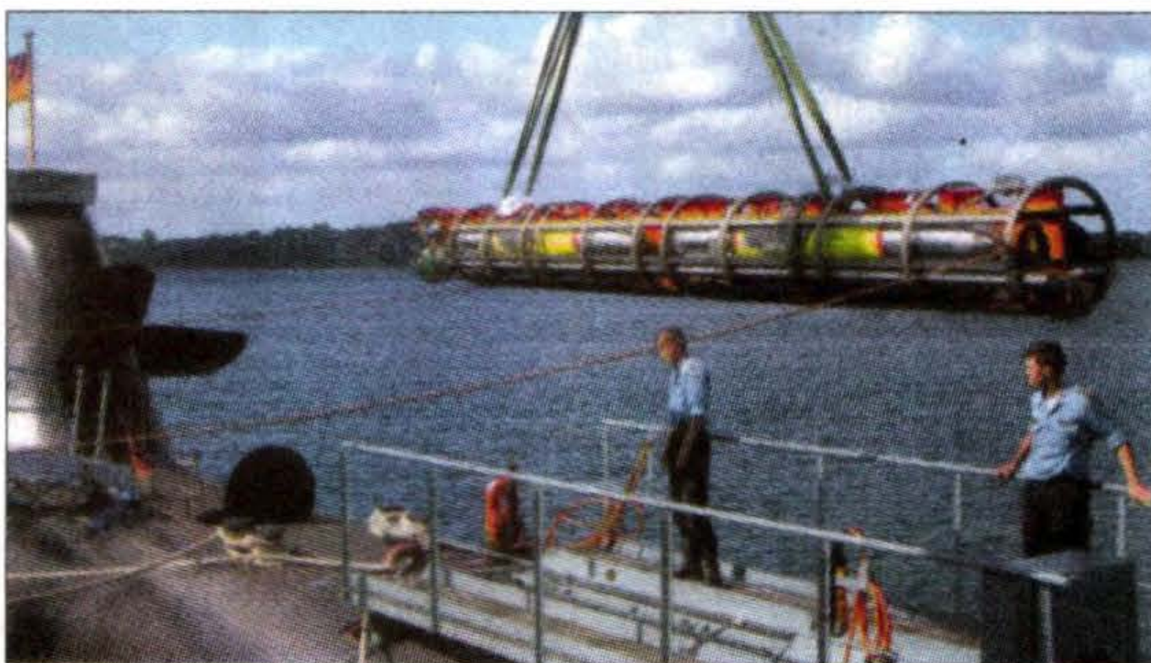
Макет многоцелевой управляемой ракеты IDAS (сверху) и погрузка транспортно-пускового контейнера (внизу) на ПЛ проекта 212А
